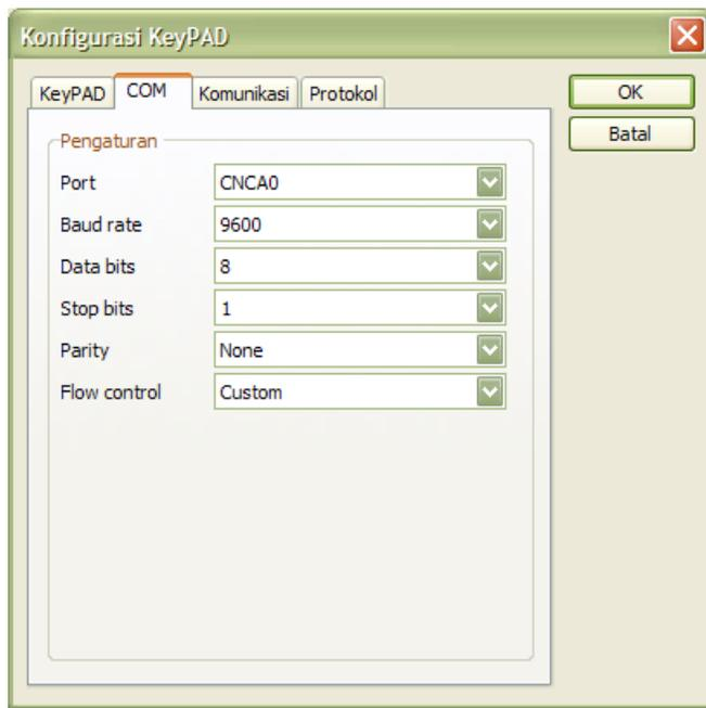
Pengaturan COM digunakan untuk menentukan lokasi Serial Port yang digunakan untuk berhubungan dengan KeyPAD, sedang pengaturan lainnya dapat dibiarkan apa adanya (default).
